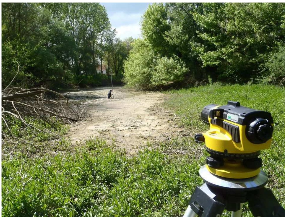
Photographie 14. Mesures topographiques sur une portion envasée du bras mort n°2 du site de Petit Gravier
