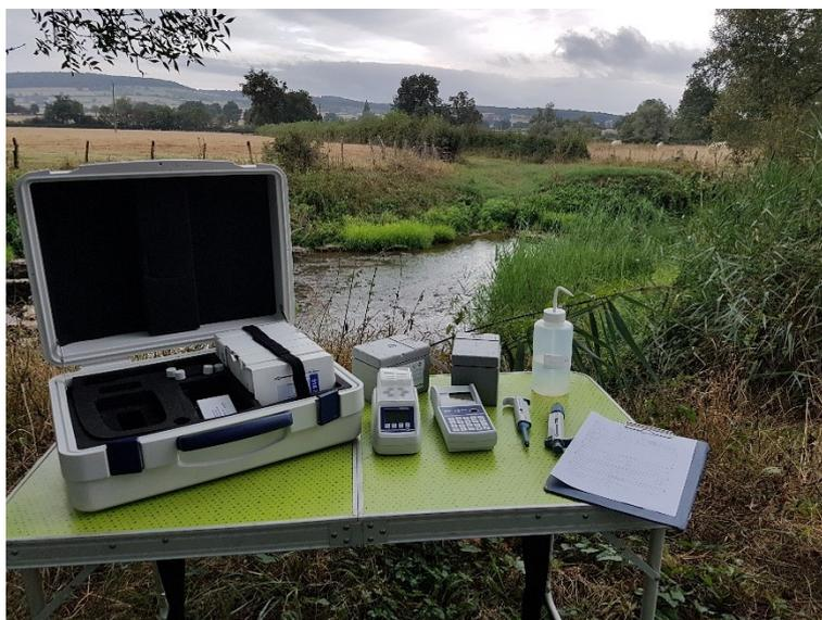
Photographie 3 : Photomètre PF12-Plus et bloc chauffant MACHEREL-NAGEL
