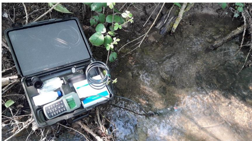
Photographie 2 : Mesure de paramètres *in-situ* en rivière avec le multiparamètre HI 98194.
