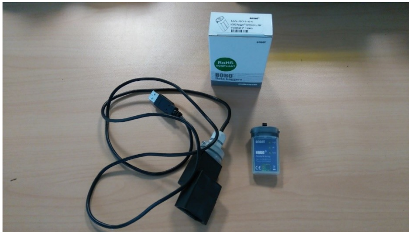
PHOTOGRAPHIE 2 : SONDE DE MESURE DE LA TEMPERATURE ET SA BASE DE TRANSFERT (USB).
