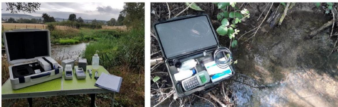
Photographie 1 : A gauche un photomètre PF12-Plus et son bloc chauffant Macherey-Nagel. A droite, un multiparamètre HI 98194 Hanna Instruments.
